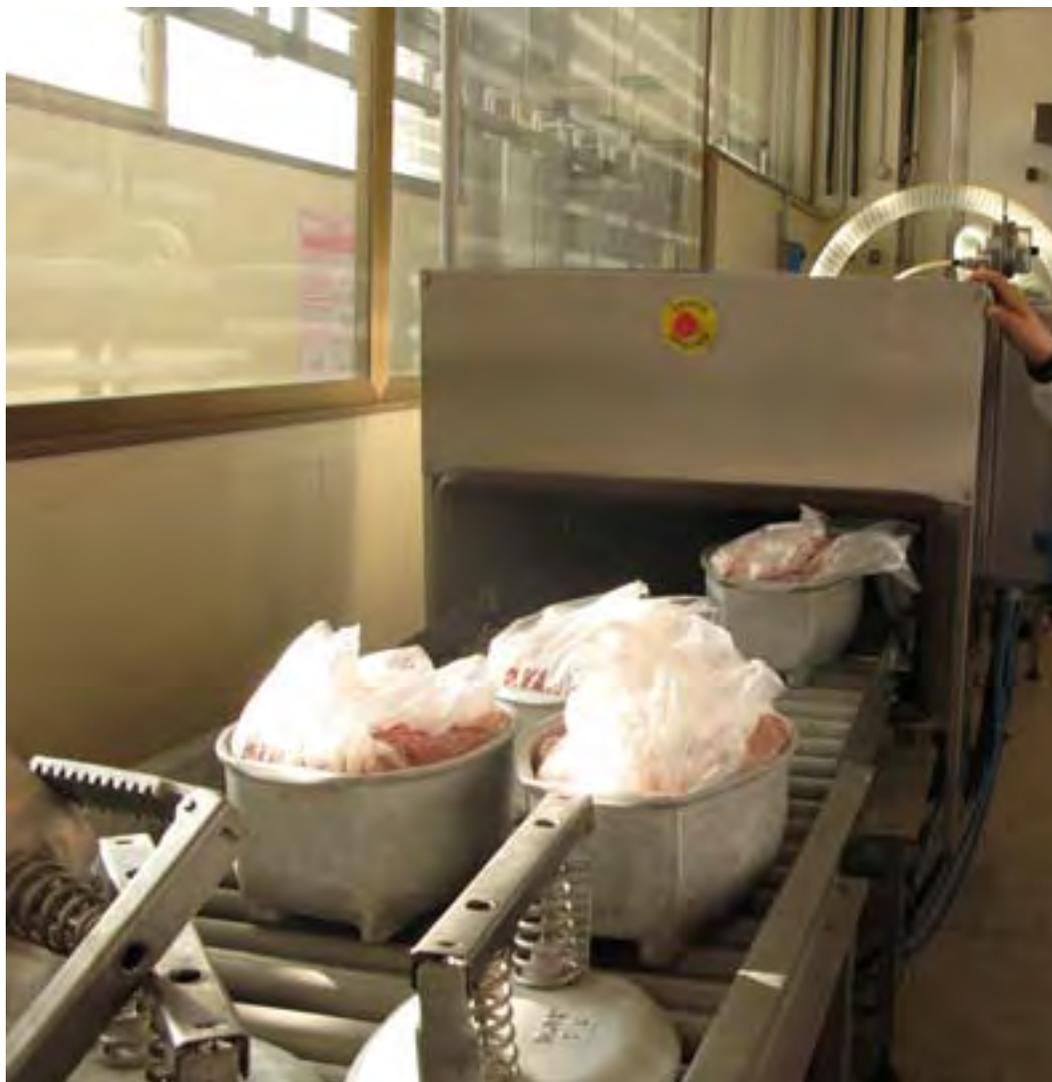
*Parallelamente ai laboratori di ricerca vengono installate attrezzature di carattere industriale, come la linea di produzione dei prosciutti cotti - qui a fianco un dettaglio del processo di stampaggio - o l'impianto pilota - qui sotto - per la salagione e il riposo dei prosciutti crudi (Archivio SSICA).*
